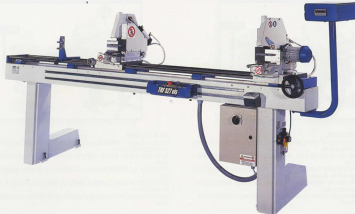
TRF 527 VIS: Manuelle Aggregatverstellung über ein Handrad, pneumatische Verriegelung des Schlittens. Das Maß wird auf einem elektronisch-digitalen Messgerät angezeigt. Ein Vorteil dieser Ausführung ist die unmittelbare Ablesung des Maßes, das mit Dezimalstellen angezeigt wird.
