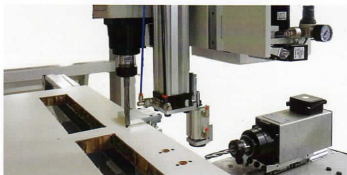
Lavorazione cerniere, serratura e sfinestratura
