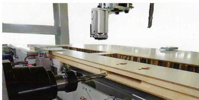
Lavorazione cerniere, serratura e sfinestratura
