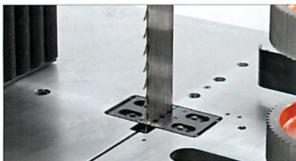
Guidalama a tasselli Chaco al piano Guidelame avec tasseaux Chaco sur la table Chaco blade guide on the table Guia-sierra ataponos Chaco on the table
