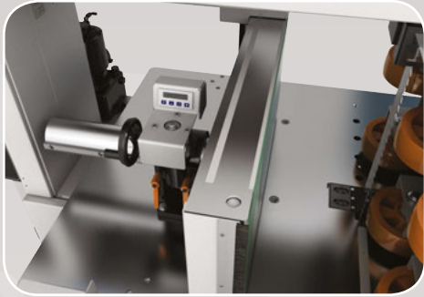
Posizionamento manuale della guida con visualizzatore digitale Manual positioning of the guide with digital display Positionnement manuel de la guide avec affichage numérique Posicionamiento manual de la guía con pantalla digital
