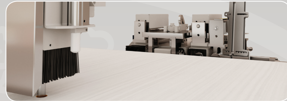
Anubatura su pannelli porta Anuba hinges process on door Fiche anuba usinage sur la porte Mecanizado de bisagra anuba por la puerta
