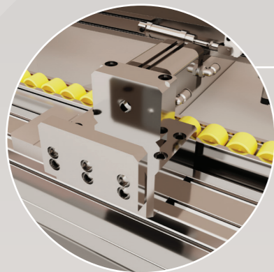
Lavorazione stipiti posizionati in verticale (simultaneo) - Processing of jambs positioned vertically (simultaneous) Usinage des cadres positionnés verticalement (simultanément) - Mecanizado de jambas posicionadas en vertical (simultaneo)
