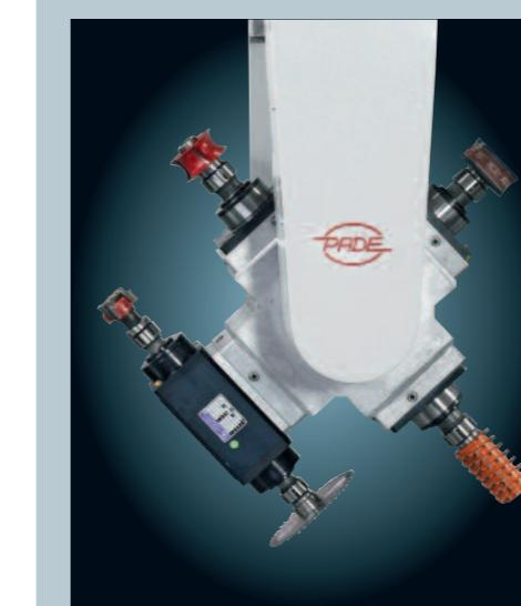
**IT** LE TESTE DI LAVORO PADE SONO CARATTERIZZATE DA UNA FORCELLA IN ALLUMINIO TEMPERATO, RIGIDA E COMPATTA, NELLA QUALE SONO ALLOGGIATI I MOTORI MANDRINO.
