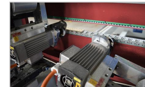
Unità di spigolatura dotate di elettromandrine a 18.000 rpm
