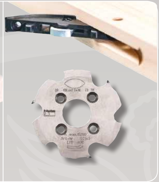
Assemblage du bois model "Lamello"
