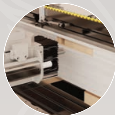
Lavorazione stipiti posizionati in verticale (simultaneo) - Processing of jambs positioned vertically (simultaneous) Usinage des cadres positionnés verticalement (simultanément) - Mecanizado de jambas posicionadas en vertical (simultáneo)
