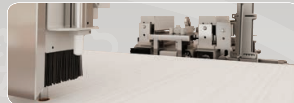
Anubatura su pannelli porta Anuba hinges process on door Fiche anuba usinage sur la porte Mecanizado de bisagra anuba por la puerta
