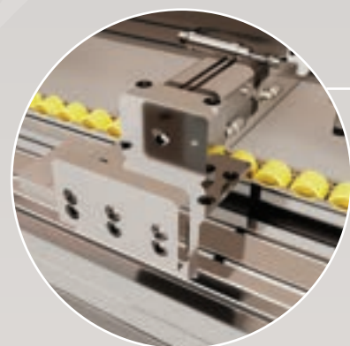
Lavorazione stipiti posizionati in verticale (simultaneo) - Processing of jambs positioned vertically (simultaneous) Usinage des cadres positionnés verticalement (simultanément) - Mecanizado de jambas posicionadas en vertical (simultáneo)
