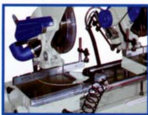
Cod. 720910511461 TR 2 - TR 2A Pressori frontali (standard nella versione CE): per un miglior bloccaggio dei pezzi durante il taglio. Frontal clamps (standard for CE version): for a better holding of the pieces during the cut.
