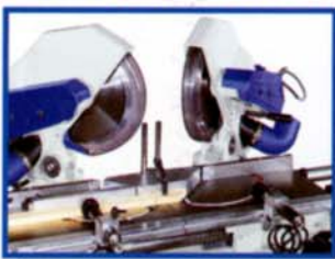
Cod. EXTRA 22° 30' Punti fissi Locking angles Festpunkte Angles fixes Ángulos fijos
