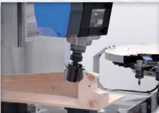
Liquid cooled electrospindle. Electromotor con enfriamiento líquido Vloeistof gekoelde freesmotor.
