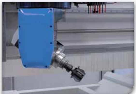
Liquid cooled electrospindle. Electromotor con enfriamiento líquido Vloeistof gekoelde freesmotor.
